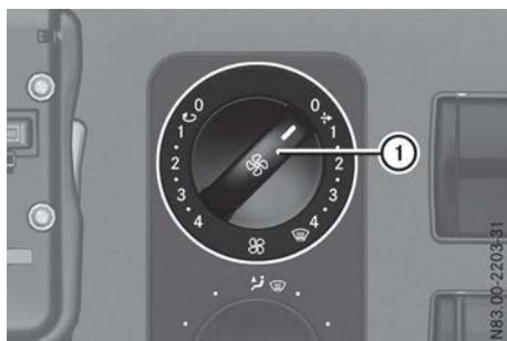
Wenn Sie den Umluftbetrieb einschalten, können die Scheiben schneller beschlagen, insbesondere bei niedrigen Außentemperaturen. Schalten Sie den Umluftbetrieb nur kurzzeitig ein.
