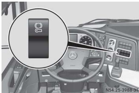
Die Haltestellenbremse hat gegenüber der Feststellbremse einen geringeren Druckluftverbrauch. Wenn Sie häufig anfahren und kurzzeitig anhalten, benutzen Sie die Haltestellenbremse, z. B. im Müllsammelbetrieb. Die Haltestellenbremse ersetzt weder die Betriebsbremse noch die Feststellbremse. Wenn Sie Ihr Fahrzeug abstellen wollen, finden Sie Informationen im Abschnitt „Anhalten und Abstellen“ (▷ Seite 178).
