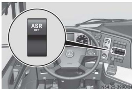
Fahrzeuge mit Stabilitätsregel-Assistent besitzen keine Taste
