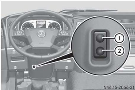
Lenksäulenentriegelung unter dem Multifunktionslenkrad
