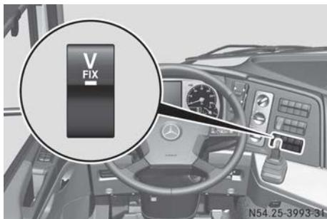
Für spezielle Fahrzeugeinsätze (z. B. für Winterdienst-Fahrzeuge) können Sie eine 2. Geschwindigkeitsbegrenzung aktivieren. Die eingestellte Geschwindigkeit ist parametrierbar.
