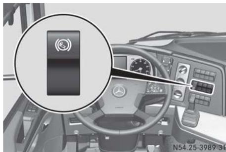
Die Rollsperre unterstützt Sie beim Anfahren an Steigungen oder im Gefälle. Die Rollsperre verhindert, dass das Fahrzeug wegrollt, und ermöglicht ein kontrolliertes Anfahren.
