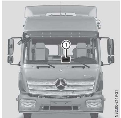
Wenn Sie die Frontscheibe regelmäßig im Bereich der Kamera ① reinigen, vermeiden Sie Funktionsstörungen.
