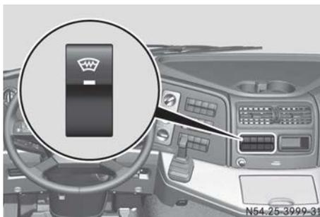
Die Frontscheibenheizung ist bei laufendem Motor betriebsbereit und schaltet sich nach etwa 15 Minuten automatisch ab.
