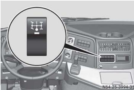
Schalter Nebenabtrieb (Beispiel getriebeabhängiger Nebenabtrieb 1)
