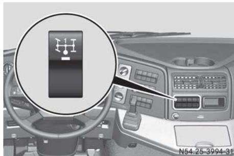
Schalter Nebenabtrieb (Beispiel getriebeabhängiger Nebenabtrieb 1)
