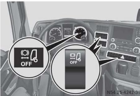
Wenn Sie den Motor starten, ist der Active Brake Assist automatisch eingeschaltet.
